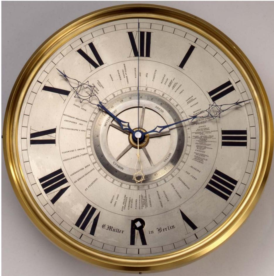
Abb. 012: Mit „C.F. Müller in Berlin“ signiertes Zifferblatt der PPU mit Weltzeitanzeige, Zentralsekunde, 2-Monatsgang und 5-Stab-Zink-Rostkompensationspendel mit Einstellung der Kompensationswirkung. Foto: Lepkowski Studios, Berlin
