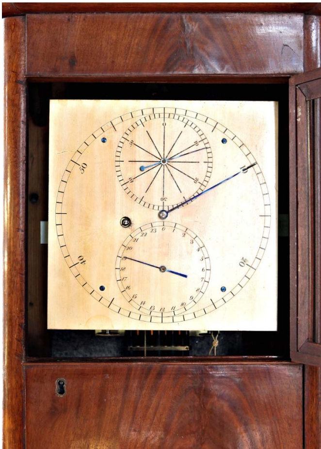
Abb. 0017. Geöffnete Kopftüre mit Blick auf das versilberte, unsignierte Regulatorzifferblatt mit 24 Stundenanzeige der Johann Georg Repsold-PPU von 1829 des Astronomen Friedrich Wilhelm August Argelander – genutzt in den Sternwarten Abo und Helsinki (Details s.u.). Foto: Helsinki University Museum
