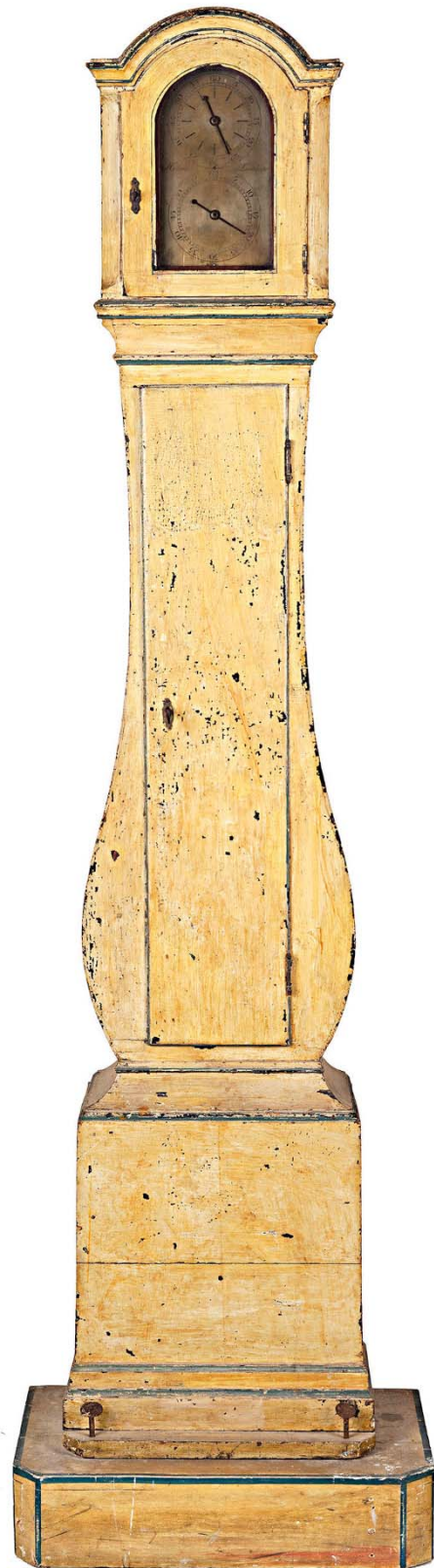
Abb. 0022: Früher englischer Journeyman-Standregulator von John Holmes, London, mit gefasstem Eichen-Gehäuse, von etwa 1770. Das Werk hat eine Graham-Hemmung; es werden auf dem versilberten Regulatorzifferblatt übereinander nur die Sekunden und Minuten angezeigt (Details s. Band 5 ). Foto: Jonathan Flower Clocks Ltd., Longford (UK)
