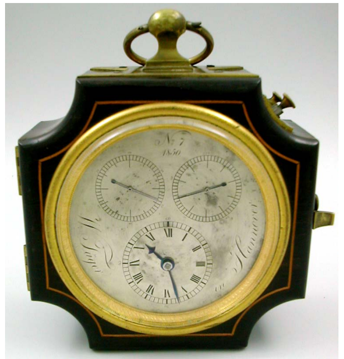
Abb. 0020: (unt.) Frühe deutsche Stopp-Uhr „No. 7“, ein so genannter Tertian-Zähler, der Stunden, Minuten, Sekunden und „Sechstel einer Zehntelsekunde“ anzeigt. Erbaut vom Hannoveraner Hofuhrmacher Wilhelm Täger im Jahr 1850. Foto: Andreas Hidding – Klassische & Antike Uhren, Raesfeld
