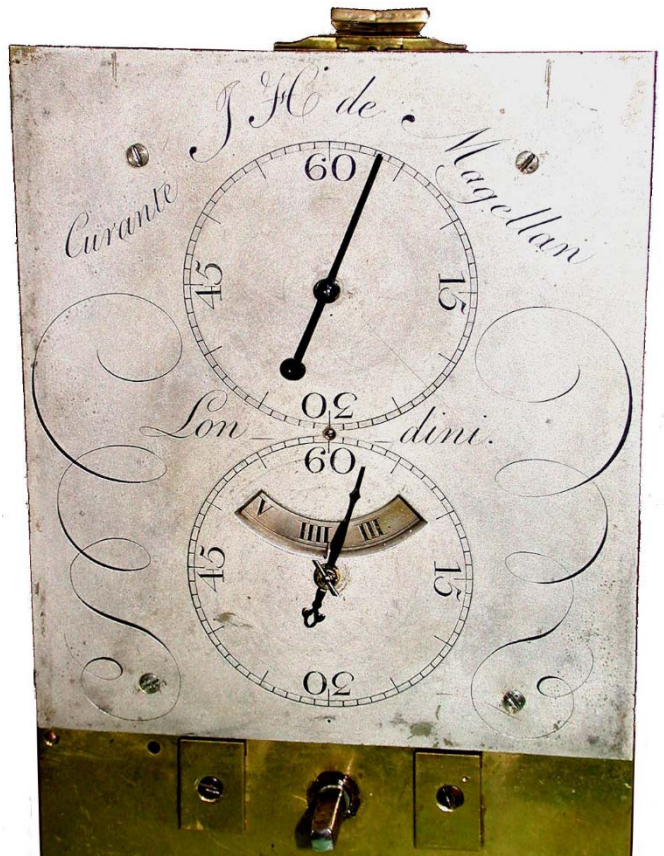
Abb. 0006: Das versilberte „Miniatur-Regulatorzifferblatt“ (Höhe nur 10,1 cm) des bedeutenden englischen ½ Sekunden-Tischregulators mit federgetriebenem 8-Tage-Pendelwerk mit Ankerhemmung mit halber Ruhe („half“ dead bead escapement), gefertigt von James Bullock, London, nach Maßgabe des portugiesisch/englischen Wissenschaftlers John Hyacinth de Magellan (Details s.u.).
