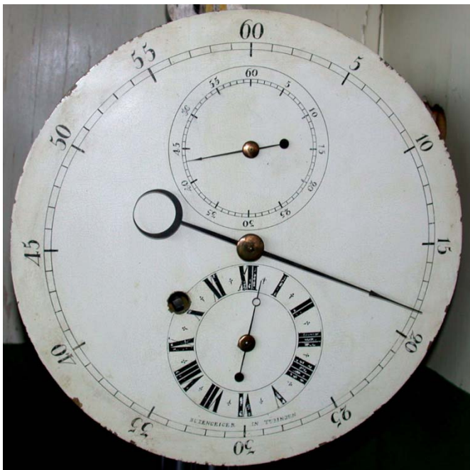
Abb. 0018: (unt.) Gemaltes Regulatorzifferblatt der Präzisionspendel-Standuhr von Johann Wilhelm Gottlob Buzengeiger. Unter dem Stundenkreis ist die Signatur „BUZENGEIGER IN TÜBINGEN“ zu sehen. Die Uhr hat ein 8-Tage-Werk mit Graham-Hemmung und einen Anker mit Steinpaletten sowie ein federaufgehängtes Rostkompensationspendel. Gefertigt etwa 1810 für den Astronomen Johann Gottlieb Friedrich von Bohnenberger, die Uhr befindet sich heute in der Universität Tübingen (Details s.u.). Foto: Alfons Renz, Tübingen
