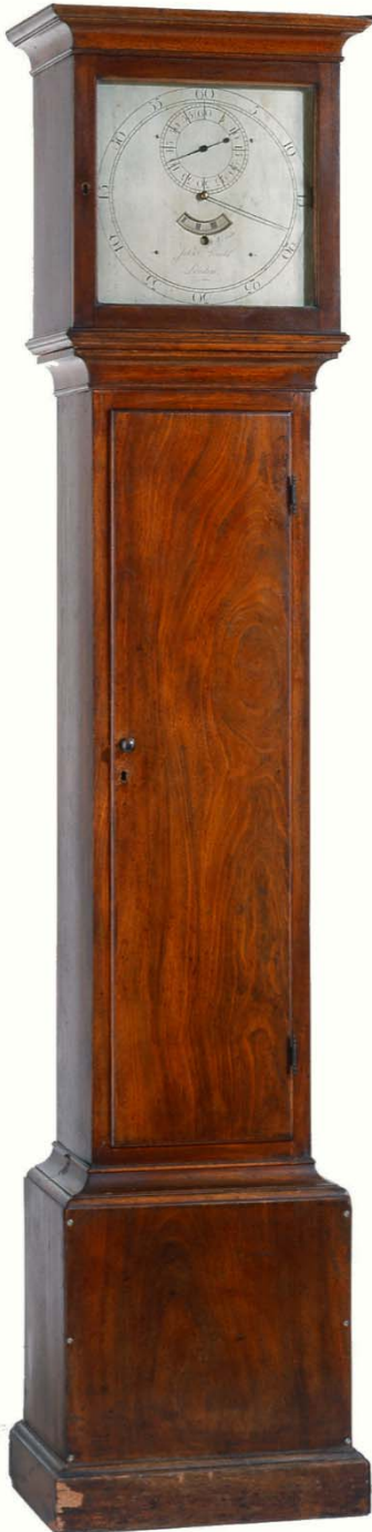
Abb. 0007: Präzisionspendeluhr mit Kompensationspendel und Monatsgang von John Arnold, die seit 1779 in der Sternwarte Mannheim eingesetzt wurde (Details siehe Band 1 ). Foto: TECHNOSEUM Landesmuseum für Technik und Arbeit in Mannheim (Fotograf Klaus Luginsland)
