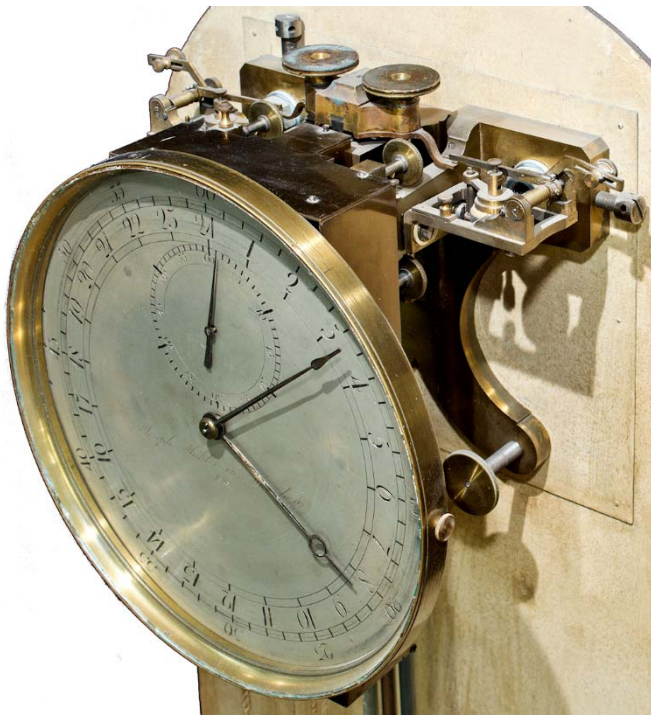
Abb. 0014: Versilbertes Zifferblatt und Werk der Präzisionspendeluhr von Franz Joseph Mahler, München, mit Graham-Gang, Huygens'schem Aufzug, 24-Stundenanzeige und Mahler'schem Kompensationspendel, 1828 (Details s.u.). Foto: Deutsches Museum, München
