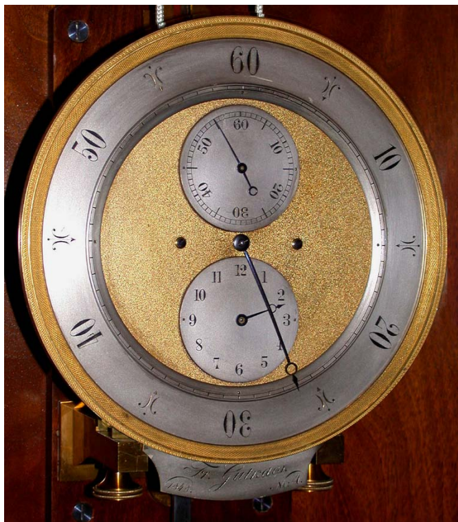
Abb. 0009: Regulatorzifferblatt der PPU mit Monatsgang und Huygens'schem Aufzug, signiert „Fr. Gutkaes – 1848 No. 4“. Das Werk dürfte wesentlich früher entstanden sein (Details s. Band 4 ).
