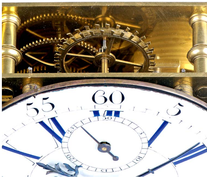
Abb. 0005: Blick auf das Hemmungsrad nach Pierre Debaufre mit einem Umlauf von 30 Sekunden in der experimentellen Louis XV.-Tischuhr von Jean-Pierre Tavernier, Paris (Details s.u.). Foto: Auktionen Dr. Crott, Mannheim
