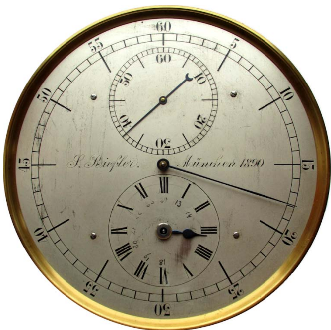
Abb. 0010: Die erste von Sigmund Riefler 1889/90 gefertigte PPU. Das Pendel hatte noch eine Schneidenlagerung aus Achat. Genutzt von Sigmund Riefler für sein D. R.-Patent Nr. 50739 „Pendel-Echappement mit vollkommen freiem Pendel mit Pendelantrieb von konstanter Größe, in der Schwingungsaxe und im Moment, in welchem das Pendel durch die Ruhelage schwingt“ (siehe Band 5 ). Foto: Dieter Riefler, Nesselwang
